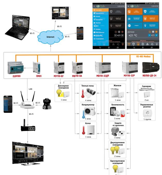
Рис. 1. Функциональная схема «УМНЫЙ ДОМ»
