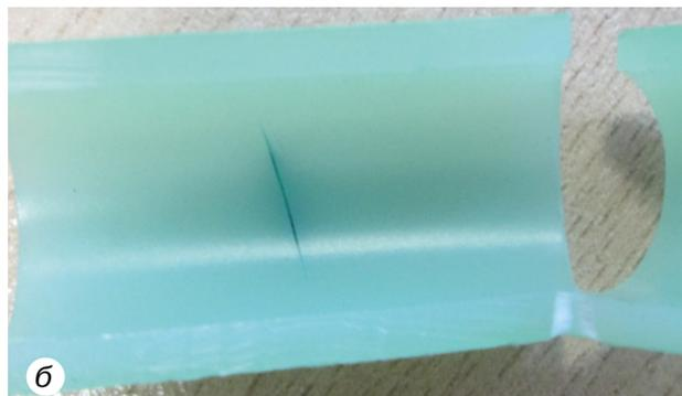
Рис. 3. Поперечная трещина в стенке трубы из PE-X: а – снаружи, б – внутри
