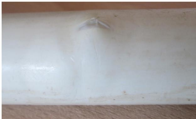
Рис. 5. Пузырь на МП-трубе, возникший в процессе эксплуатации
