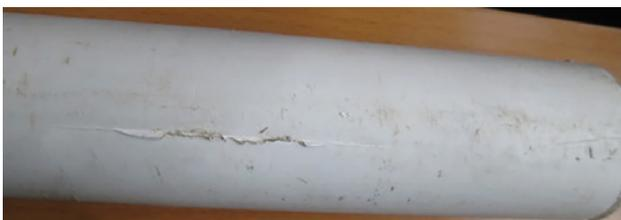
**Рис. 1.** Трещина на образце трубы PP-R без маркировки
