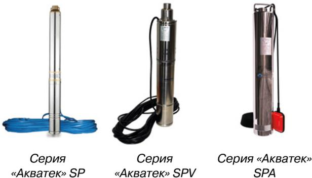
Данные виды насосов предназначены для перекачивания чистой воды из скважин, колодцев, резервуаров, водоемов для систем индивидуального водоснабжения и полива. Насосы могут использоваться как для неглубоких скважин, так и для скважин глубиной до 100 м. Их компактность (диаметр насоса – от 2” до 3,5”) позволяет осуществлять монтаж насосов в скважинах с диаметром обсадной трубы от 63 мм. Это минимальный размер трубы, используемый организациями по бурению скважин.
