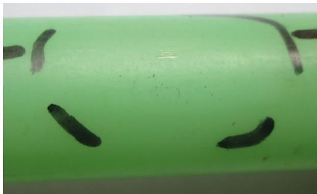
Рис. 4. Продольная трещина в стенке трубы из РЕ-Х
