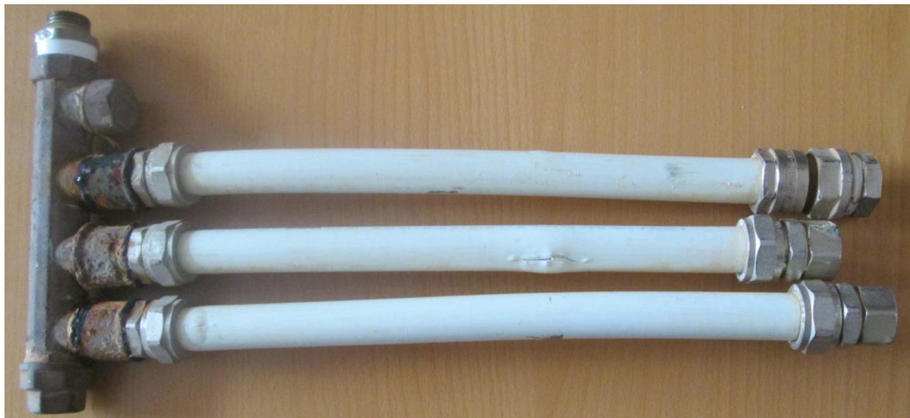
Рис. 6. МП-трубы после испытания на стойкость при постоянном внутреннем гидростатическом давлении (внизу – новая)
